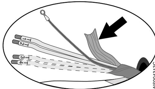
**Рис. 6: Медная фольга на проводах цепей контроля.**
